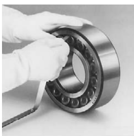
Rys. 1. Sprawdzanie luzu łożyska na podstawie.
