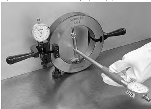
Rys. 1.11 Ustawianie średnicy wpisanej sprawdzianu GN
