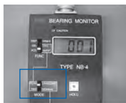
Rejestrowanie drgań spowodowanych przez rysę wewnątrz łożyska (ENVELOPE)
