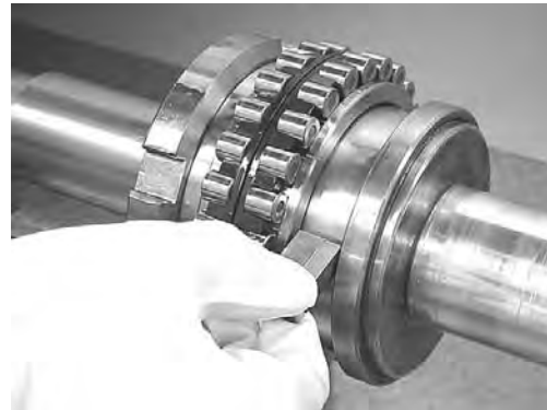
Rys. 1.5 Pomiar szerokości przekładki
