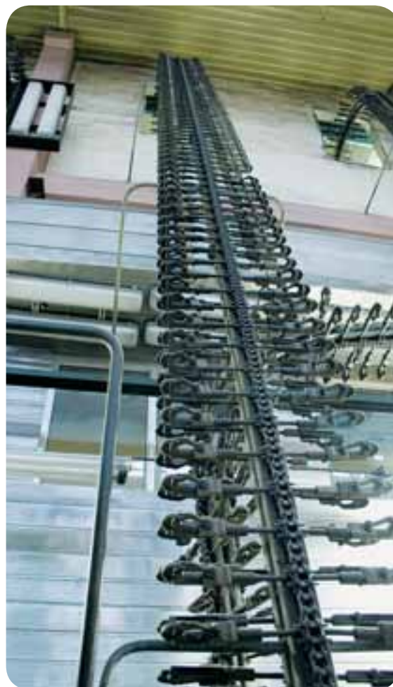
Łańcuch ze sworzniami drażonymi zastosowany na przenośniku gazet
