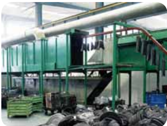
Linia wstępnego smarowania łańcuchów
