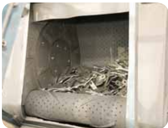
Kuleczkowanie elementów polepsza odporność zmęczeniową i odporność na pękanie
