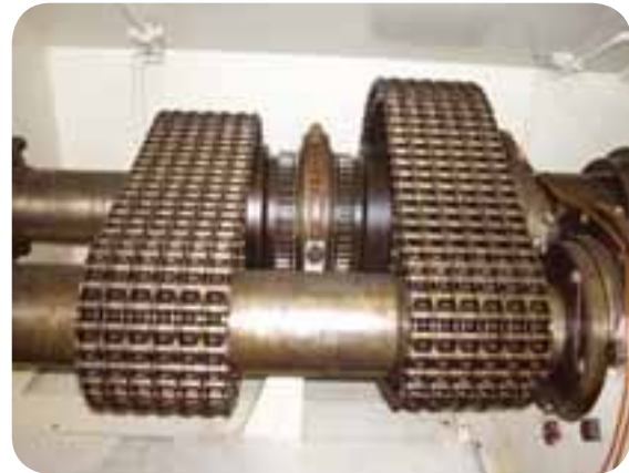
Wielorzędowy łańcuch do pól naftowych wewnątrz pompy płuczkowej
