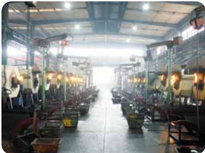
Do obróbki cieplnej sworzni są stosowane piece obrotowe zapewniające równomierne rozprzodzenie ciepła.
