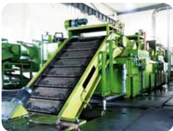
Piec przenośnikowy stosowany do obróbki cieplnej sworzni i tulei np. do węglaozotowania.
