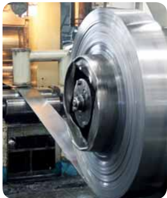
Prostownica rolkowa stosowana do uzyskania równomiernej grubości blachy
