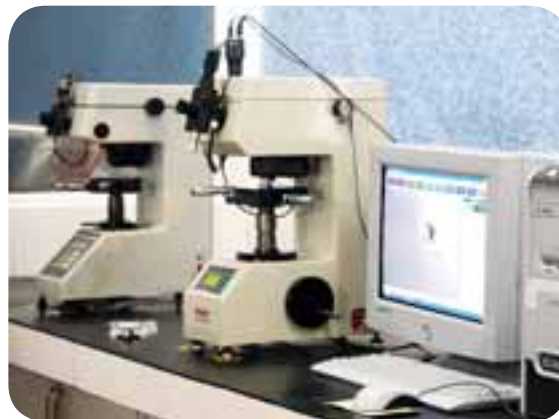
Sprzęt do badania mikrotwardości, gdzie przeprowadzane są testy partii produkcyjnych sprawdzające, czy twardość jest zgodna ze specyfikacją
