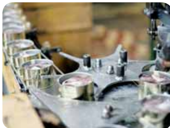
Łańcuch niklowany na linii puszkowania
