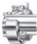
Figuur 4. De hydraulische moer gebruikt voor de montage van een lager op een trekbus
