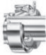
Bild 4. Einbau eines gegen einen Anschlag abgestützten Lagers auf Spannhülse
