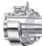
Figure 6. Écrou HMV et écrou à butée spéciale pour monter à l'aide d'un manchon
