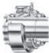
Figur 8. HMV-mutter och mothållsring i position för att trycka loss en klämhylsa
