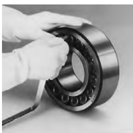
Rys. 1. Sprawdzanie luzu łożyska na podstawie.
