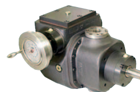
osiowa pompa tłokowa REXROTH typ A2VK
