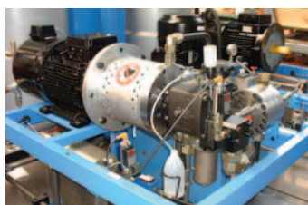
bezosługowa instalacja pompy dozującej alkohol wielowodorotlenowy oraz izocyjanian w wysokociśnieniowych wtryskarkach PUR
