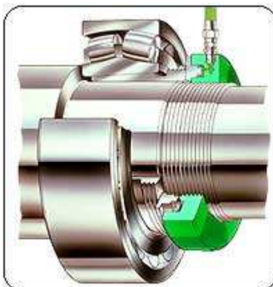
Nakrętka HMV E nakręcona na wał w celu montażu łożyska na tulei
